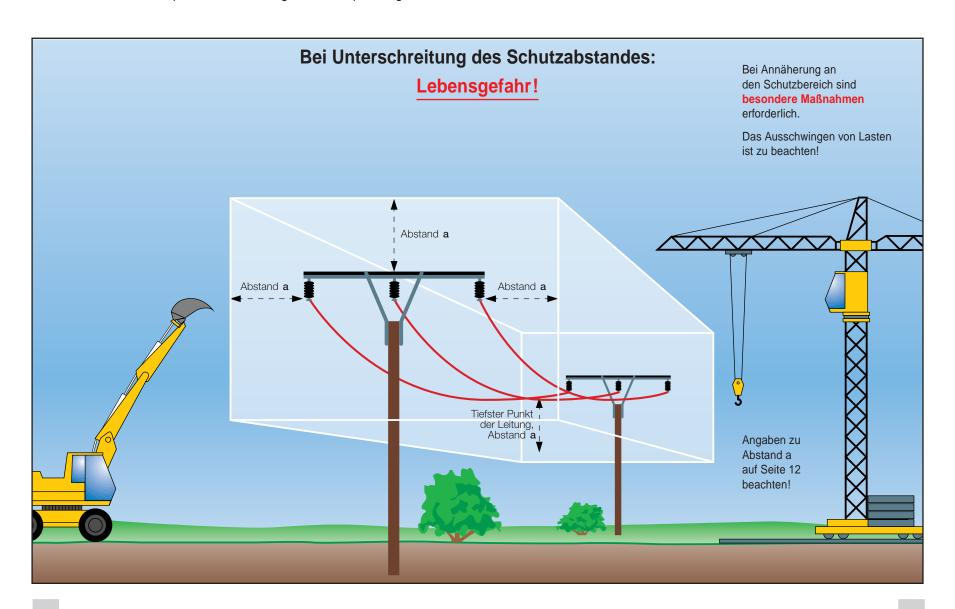
Schutzabstände am Beispiel einer Freileitung mit einer Spannung von 110 000 Volt, **mit** und **ohne** Windeinfluß
