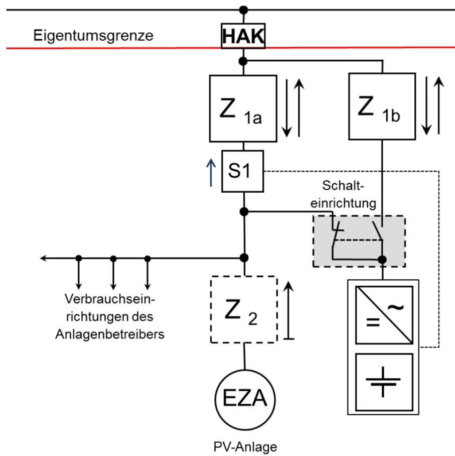
Abbildung 18: Speicher mit Mehrfachanwendung durch Umschalten
