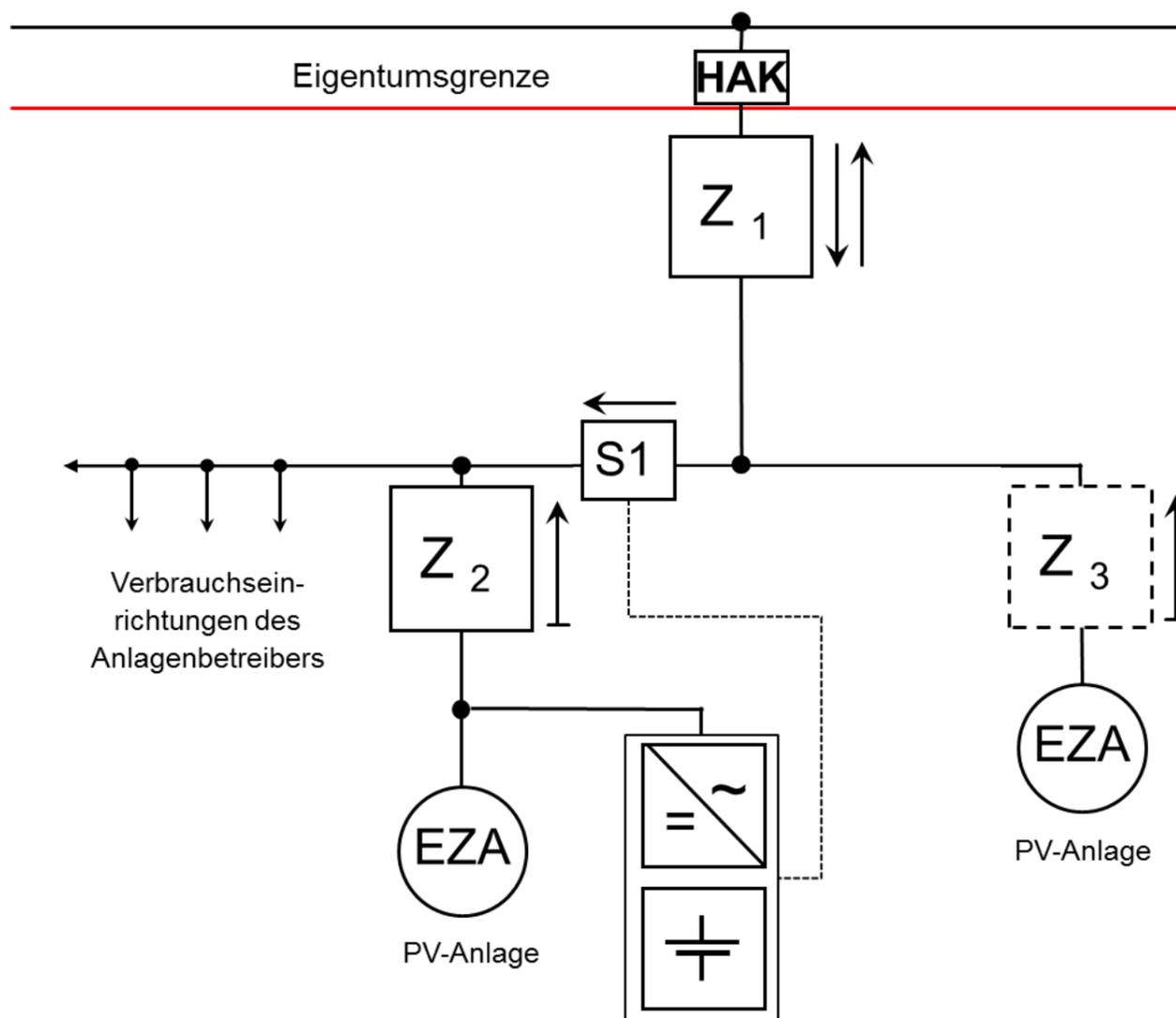
Abbildung 6: Speicher im Erzeugungspfad mit weiterer PV-Anlage
