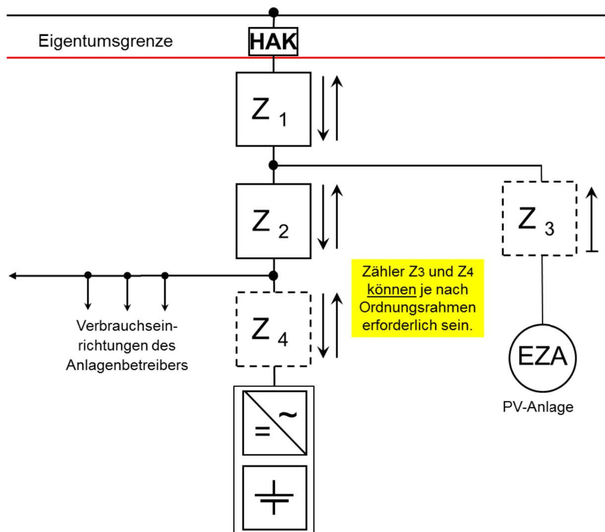
Abbildung 17: Beispiel einer Mehrfachanwendung (Regelenergie)
