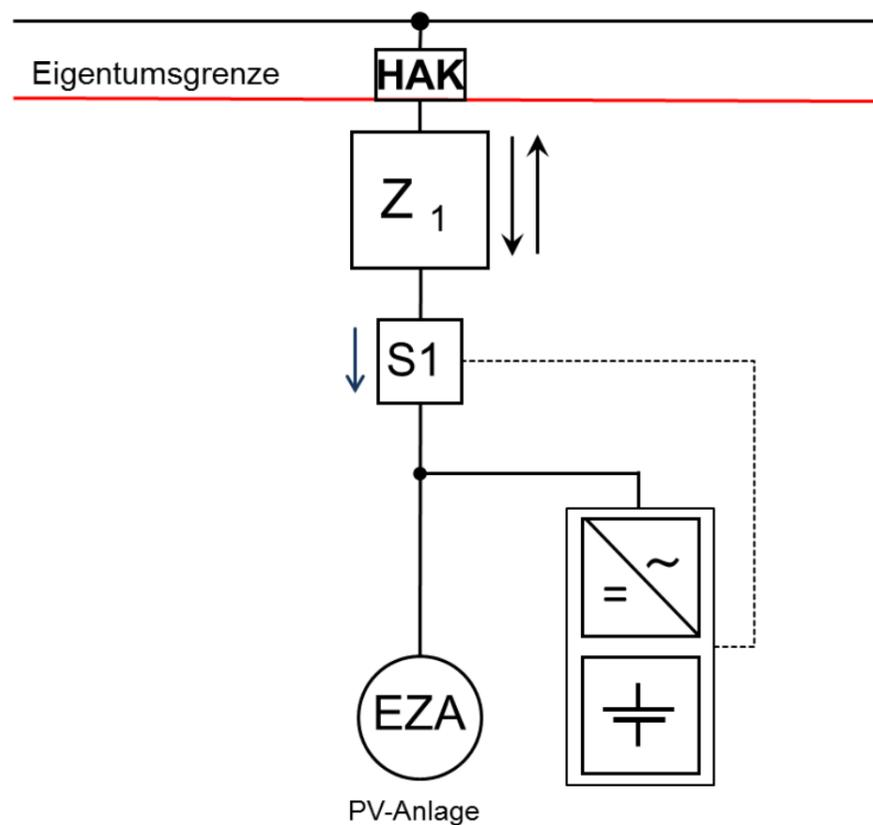
Abbildung 4: Erzeugungsanlage mit Speicher ohne Verbrauchseinrichtung
