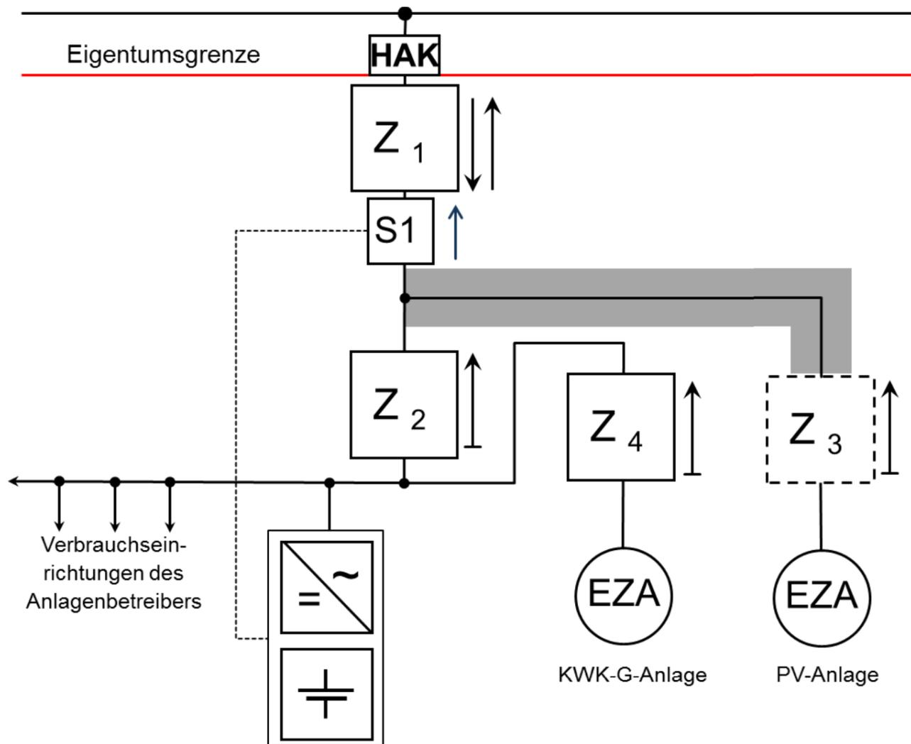
Abbildung 12: Speicher im Verbrauchspfad mit KWK-Anlage
